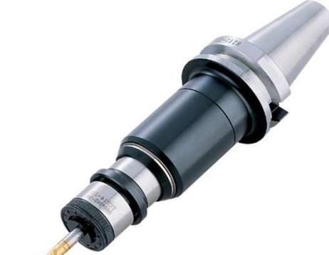
>construído em aço ferramenta 8620;
